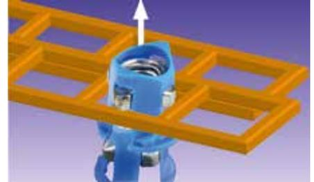
Einsetzen und Anziehen der M6 Schraube fixiert das Gewindeelement
