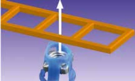
Die Käfigmutter von vorn in den Ausbruch des Profils einsetzen
