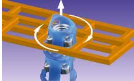
Eine Vierteldrehung nach rechts fixiert den Kunststoffkörper der Käfigmutter
